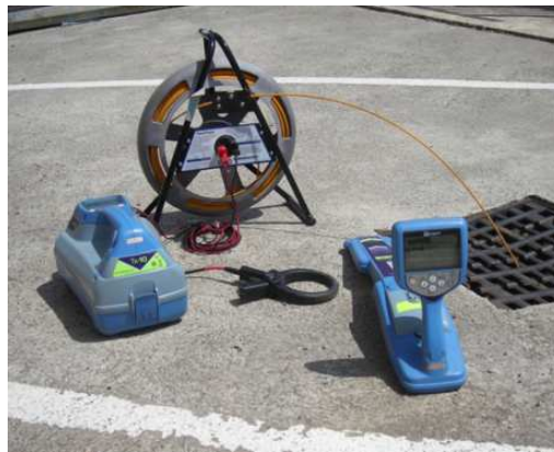
Exemple de passage d'une aiguille détectable couplé à un générateur (mode actif) dans un réseau gravitaire
